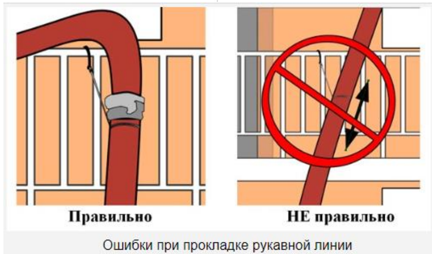
Прокладка пожарных рукавов магистральной линии на 9 этаж
