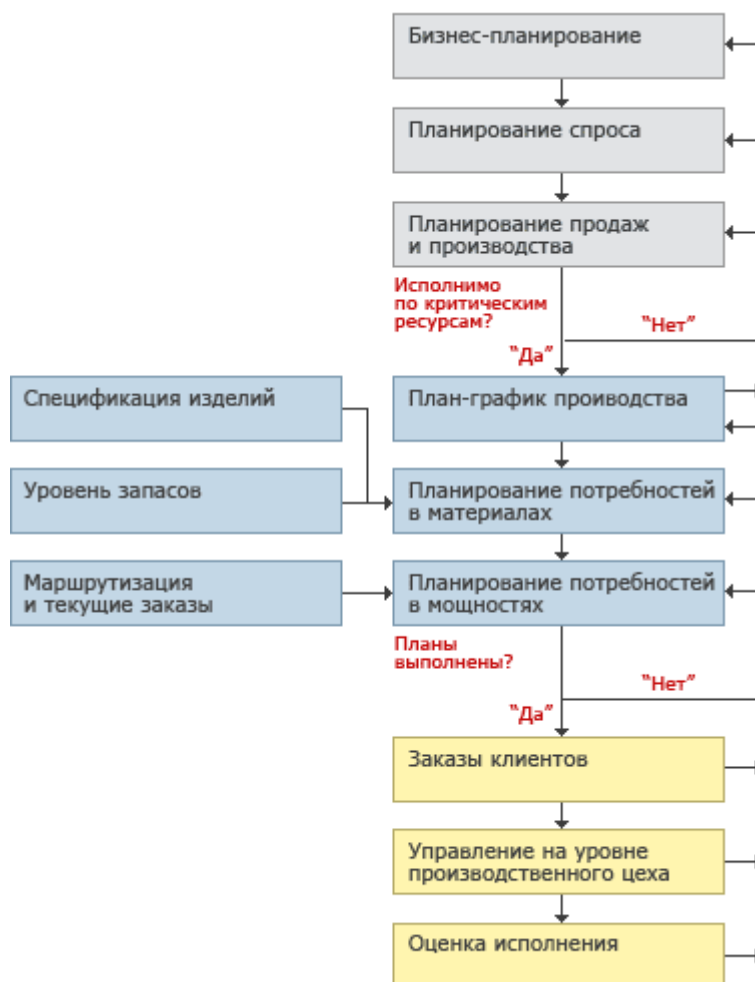
Рис. 3. Алгоритм производственного планирования по стандарту MRP II
