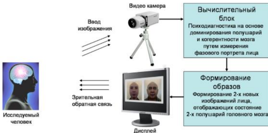
Схема видеокomпьютерного аппаратно-программного комплекса психодиагностики и коррекции на основе биологической обратной связи
