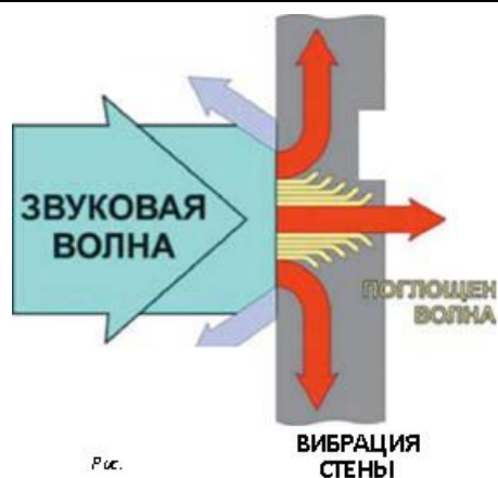
Рис. 7.4.1. Акустический и виброакустический каналы утечки
