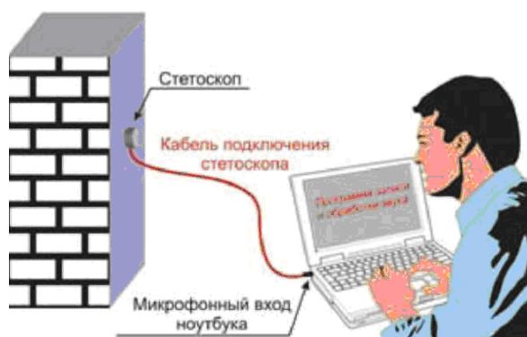
Рис. 7.4.4. Перехват акустической информации со стен и перекрытий можно с помощью стетоскопа
